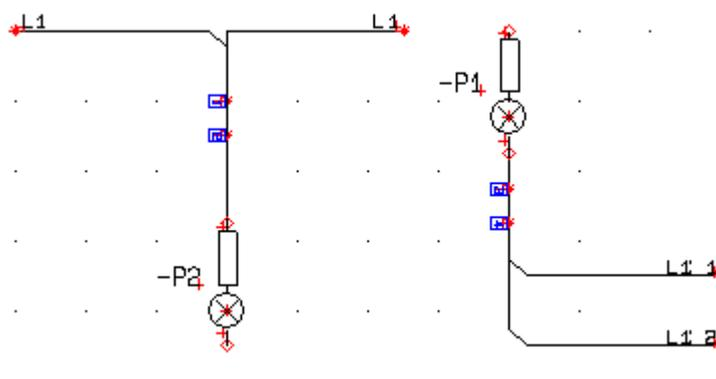
如果看上面的图，线号被布置在常规的走线上。这种情况只有在老的模式下才出现。可能会使您不容易分辨出哪个线号属于哪条线。在新的模式下，避免了这种情况的发生。产生的结果如下图：
