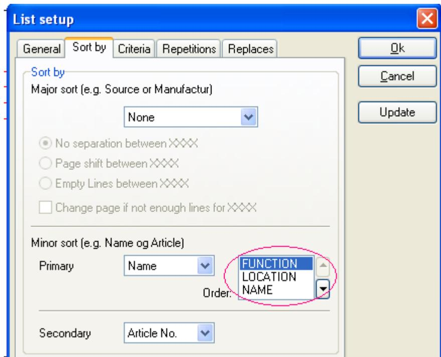
比如，如果需要在清单中把位置 +A1 的所有元件列在一起，可以拖动“位置”到上图中显示的小窗口的最上端，或者在右边的“顺序”窗口中，使用箭头移动它。如果拖动“名称”到“顺序”窗口的最上端，则所有的-K1 元件都会在清单中排列在一起。前面的顺序是“功能”，“位置”，最后是“产品”。
