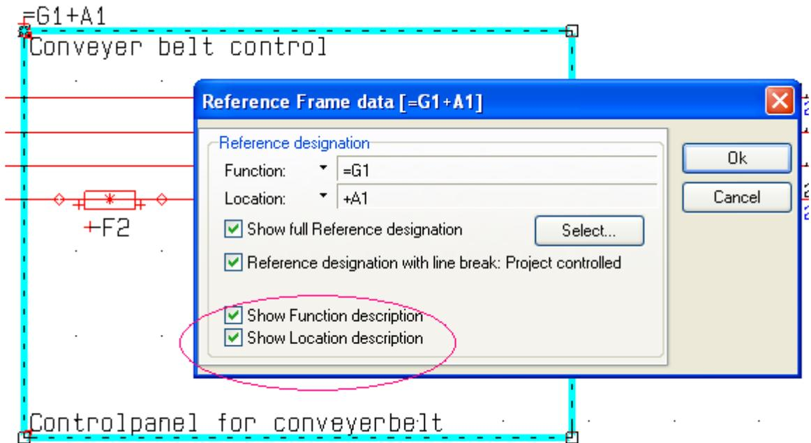
功能参考指示的描述显示在参考框的左上角，位置参考指示的描述显示在参考框的左下角。所有的文字都可以单独移动。如果参考框移动了，文字也会相应移动。
