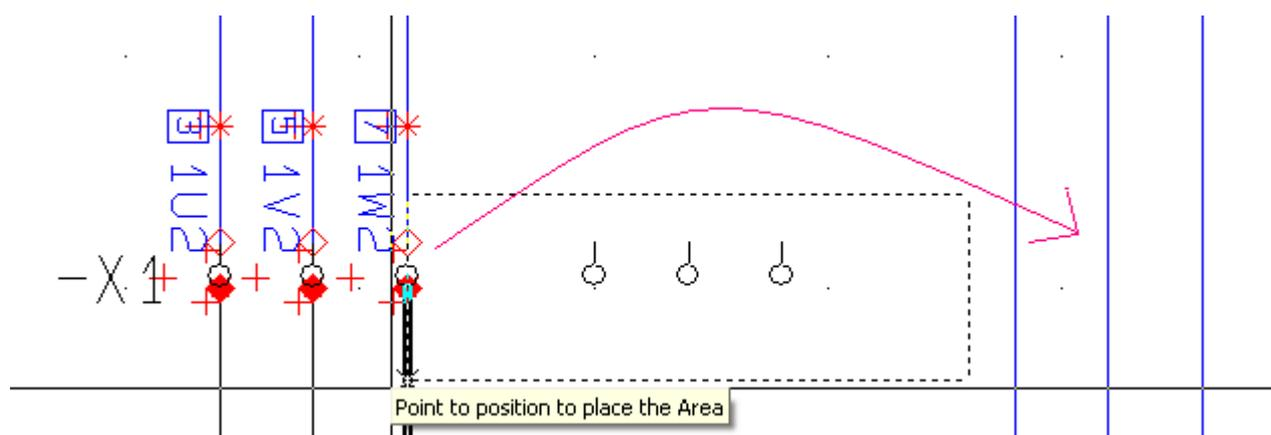
在上面的例子中，3个接线端子已经和线条连接，那么复制时会只复制符号。
