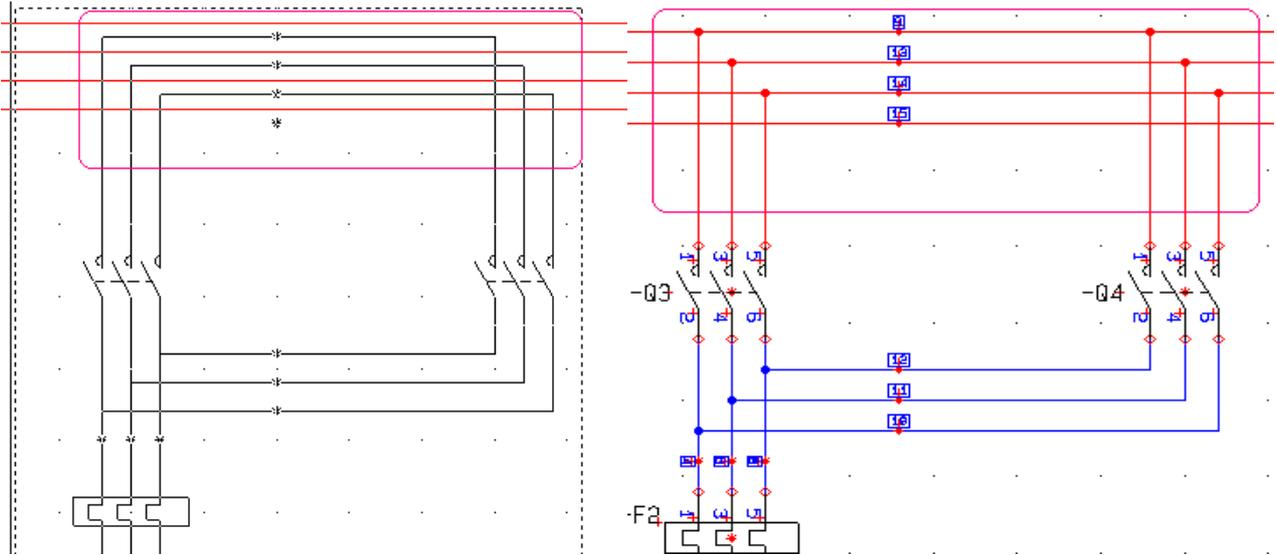
如果复制的区域有 3 条水平线，和最上面的 3 条电源线重叠，那么重叠的线会被删除，留下来的线会连接到 3 条电源线。
