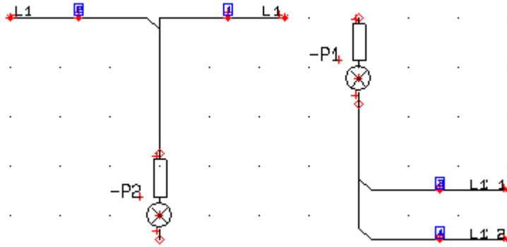
使用菜单“功能|特殊功能|转换到分支”，可以把老的模式下的重叠的线，转换为新的模式下的分支后，线号会被移动到正确的位置。
